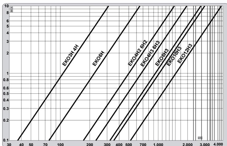
Resultados obtenidos en nuestras instalaciones de prueba con instrumentos homologados, usando agua limpia como fluido para la evaluación y mallas Lama de 190 µm.
