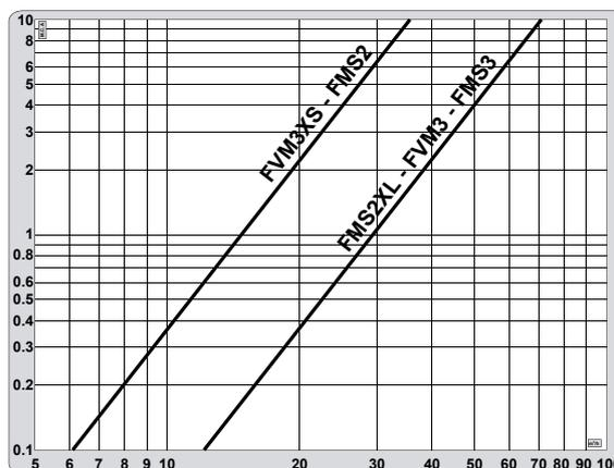
Resultados obtenidos en nuestras instalaciones de prueba con instrumentos homologados, usando agua limpia como fluido para la evaluación y mallas Lama de 130 µm.
