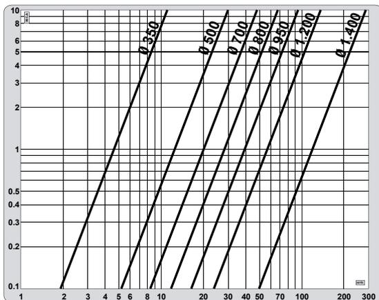
Resultados obtenidos en nuestras instalaciones de prueba con instrumentos de medida homologados, con la utilización de agua limpia como fluido para la evaluación y arena volcánica de 1,2mm.
