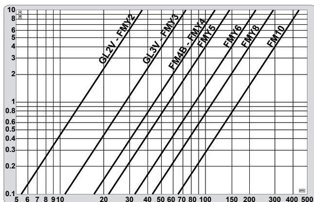
Resultados obtenidos en nuestras instalaciones de prueba con instrumentos homologados, usando agua limpia como fluido para la evaluación y mallas Lama de 130 µm.
