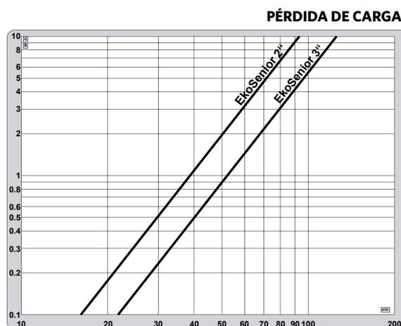
Resultados obtenidos en nuestras instalaciones de prueba con instrumentos homologados, usando agua limpia como fluido para la evaluación y mallas Lama de 190 µm.
